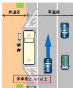
図 3-8 停車帯 (2.0m 以上) のイメージ
