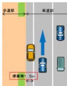
図 3-6 停車帯 (1.5m) のイメージ
