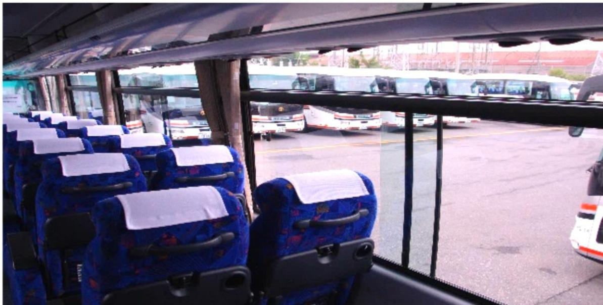
●走行中の窓明け(約5cm程度)により、2~3分で車内換気完了。
